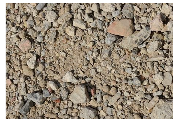
Figure 212 : Exemple de revêtement GNT 0/60
