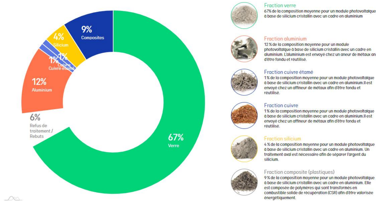
Figure 45 : Différentes fractions composant un panneau photovoltaïque (Soren)
